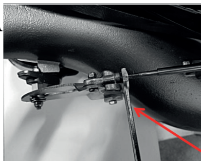
С - ИСПОЛЬЗУЙТЕ ГАЕЧНЫЙ КЛЮЧ, ЧТОБЫ ЗАТЯНУТЬ ГАЙКУ
